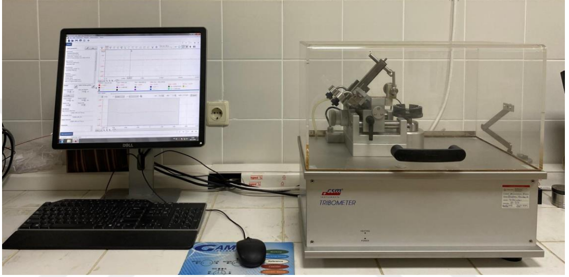
Şekil 5.6. CSM Instruments Tribometer aşınma cihazı.
