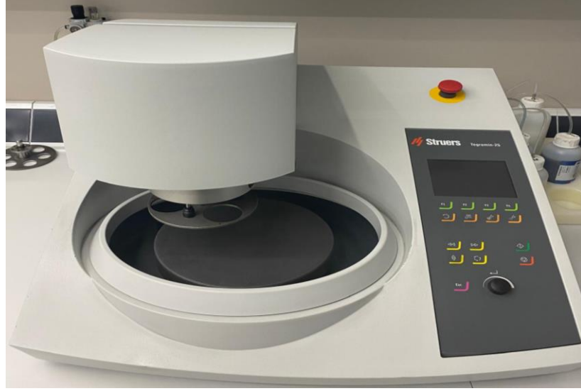
Şekil 5.2. Struers Tegramin-25 zımparalama ve parlatma cihazı.
