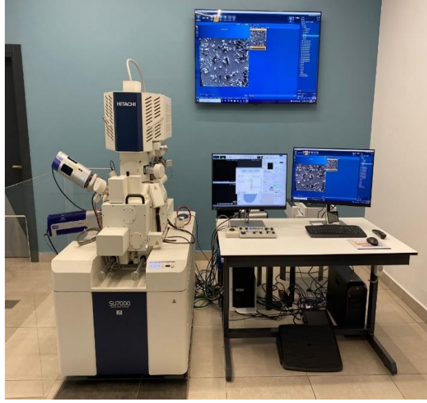
Şekil 5.4. HITACHI SU7000 taramalı elektron mikroskobu.
