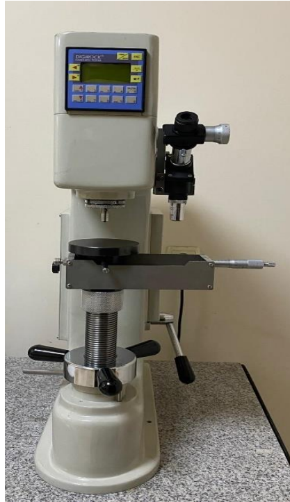
Şekil 5.5. Dıgirock makrosertlik cihazı.
