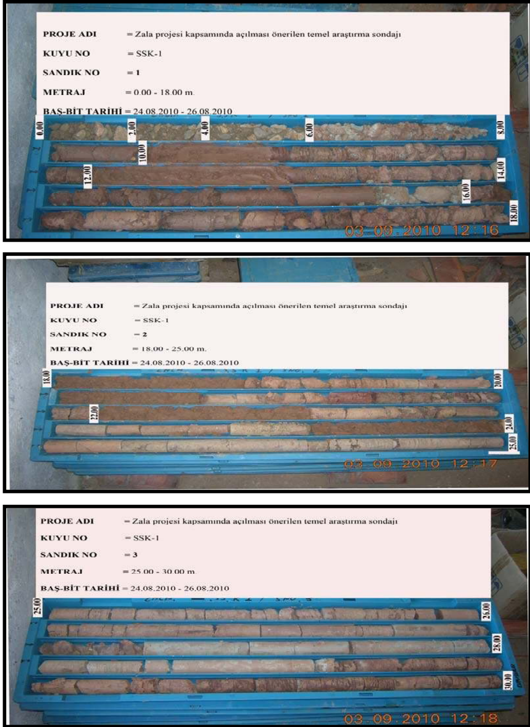
Şekil 3.13. Açılan SK-1 nolu sondajın karot sandıkları. (a ) 0.00-18.00 m,(b) 18.00-25.00 m, (c) 25.00-30.00 m arası karot sandıkları gösterilmiştir. (kot: 567 - 537 m)
