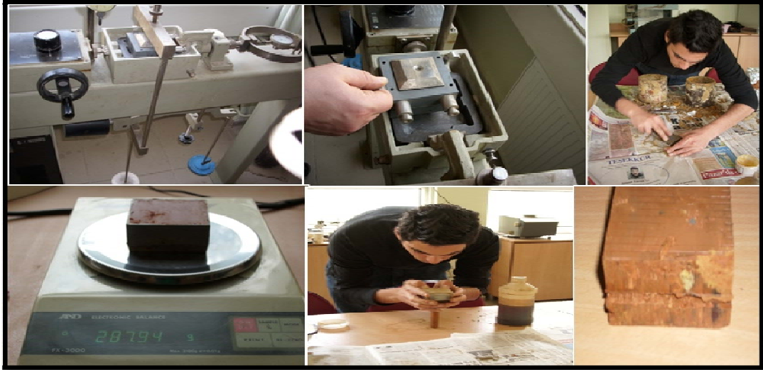
Şekil 2.5 Kesme kutusu deney aleti ve deneyin yapılışı
