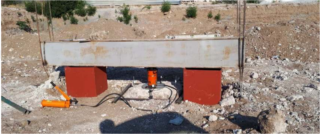
Şekil 2.45 Kazık yükleme deneyi
