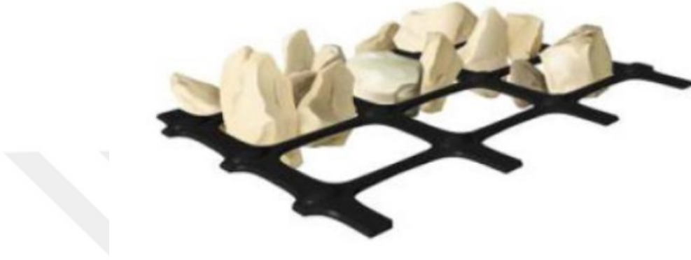
Şekil 2.20 Zemin içerisindeki geogridin çalışma şekli
