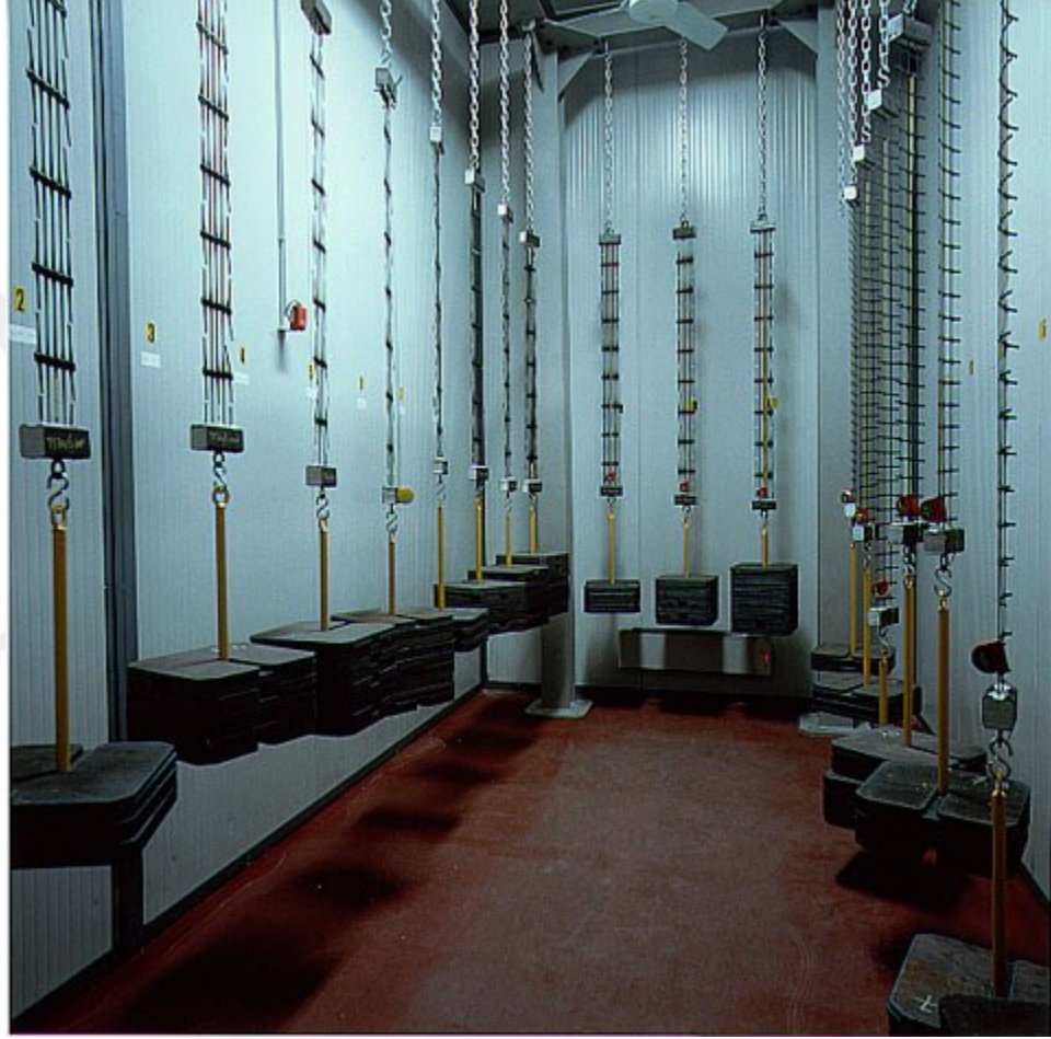
Şekil 2.21 Geogrid sünme testi laboratuvarından bir görüntü (Tenex Fabrikası,İtalya)
