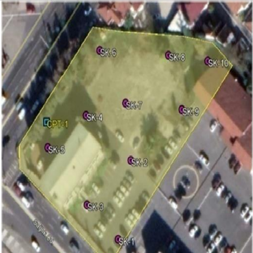
Şekil 10.3. İnceleme alanında açılan sondajların temel alanındaki konumlandırılmaları.
