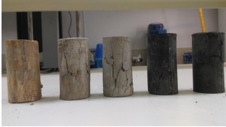
Şekil 5.14: Serbest basınç deney numunelerinin deney sonrası görüntüsü.
