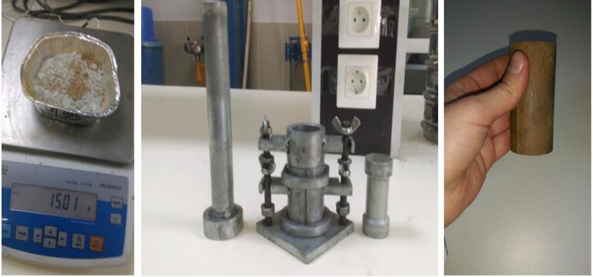
Şekil 5.12: Serbest basınç deney kalıbı ve deney aşamaları.
