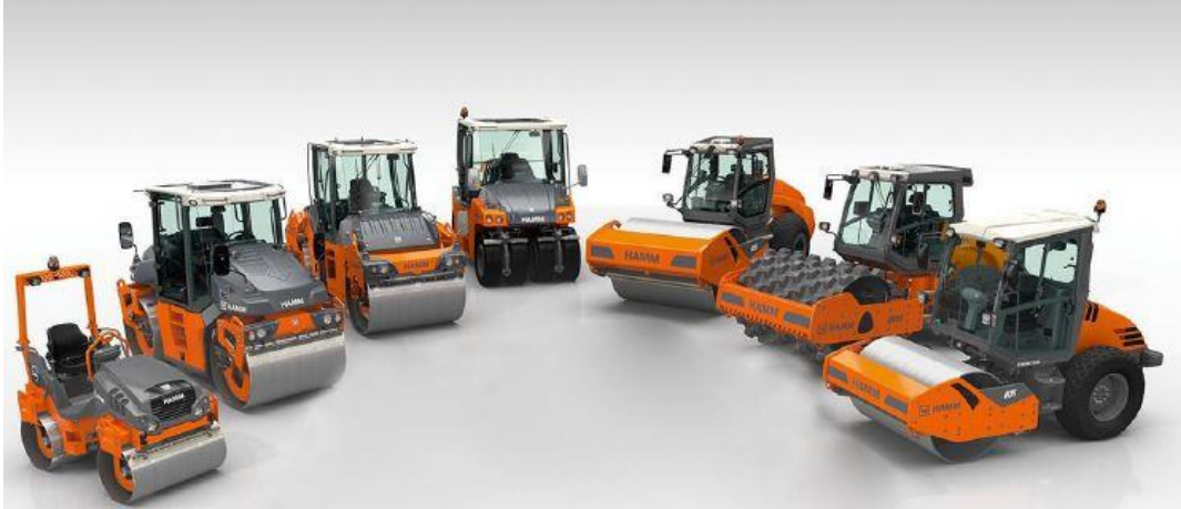
Şekil 2.7: Yüzeysel kompaksiyonda kullanılan sıkıştırma makineleri [10].
