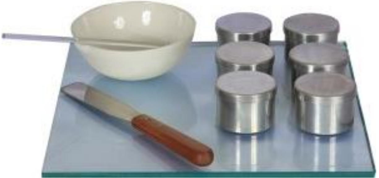
Şekil 2.9. Plastik limit deney seti (URL-10).
