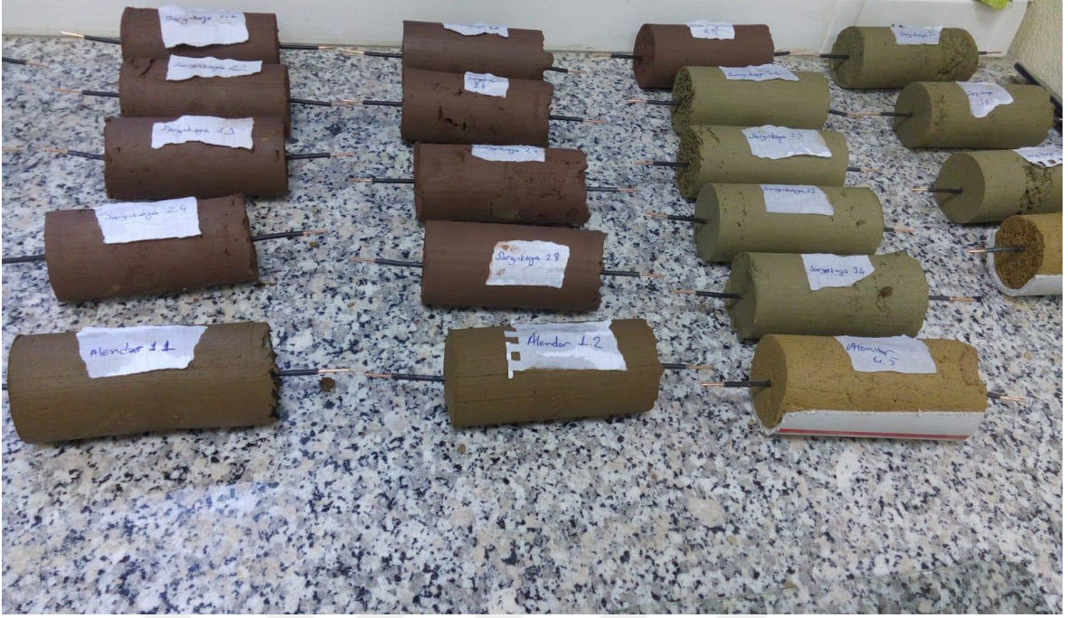
Şekil 2.17. Kalıptan çıkarılmış Alemdar- Sarginkaya bölgelerinin numuneleri
