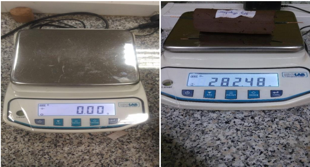
Şekil 2.15. a) Hassas terazi b) Hassas terazide numune ölçümü
