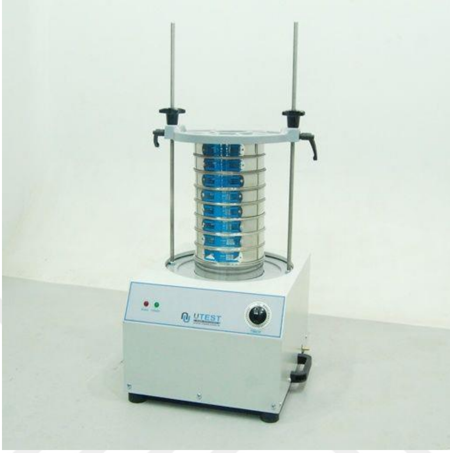
Şekil 2.8. Elek takımı ve sarsma tablası (URL-9).
