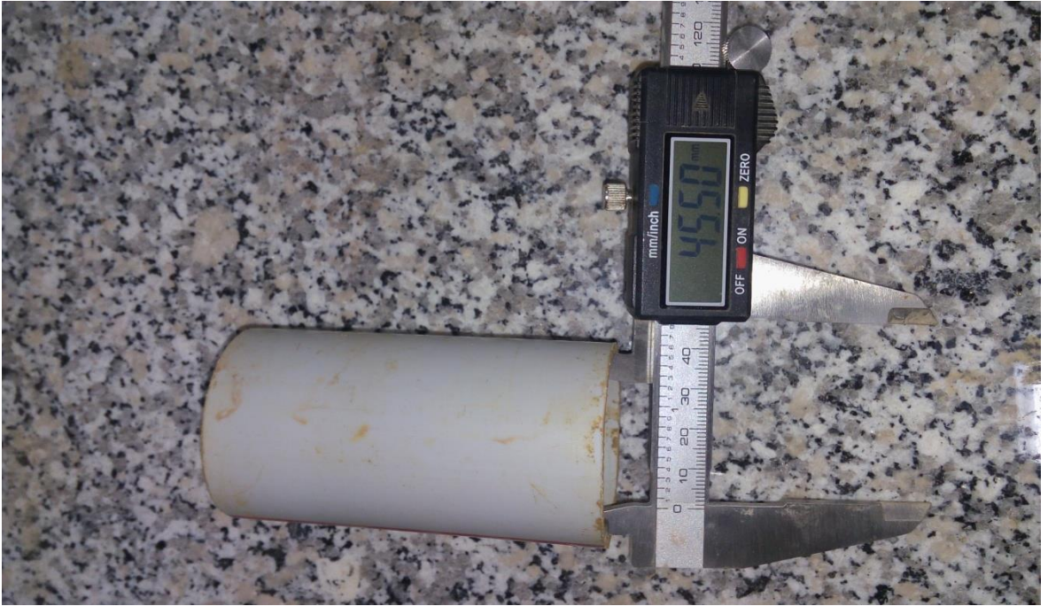
Şekil 2.13. Numune kalıbının çapının kumpas ile ölçümü
