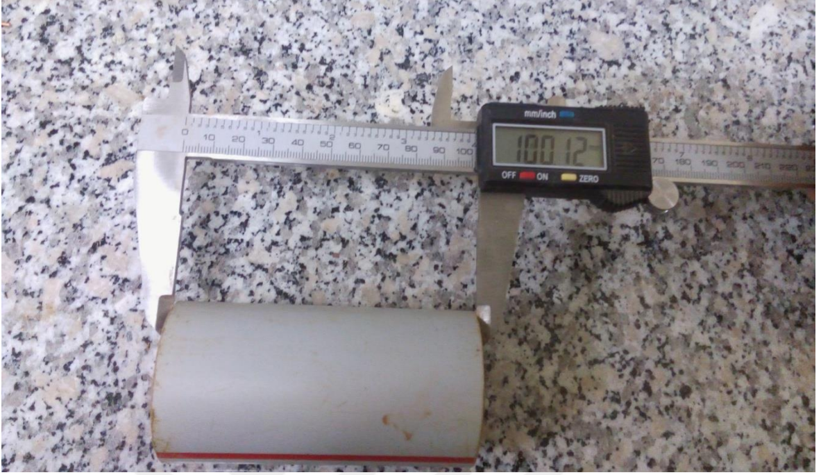
Şekil. 2.12. Numune boyunun kumpas yardımıyla ölçümü
