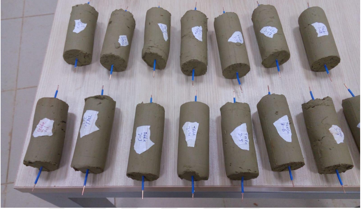
Şekil 2.19. Kalıptan çıkarılmış Tekke bölgesi numuneleri
