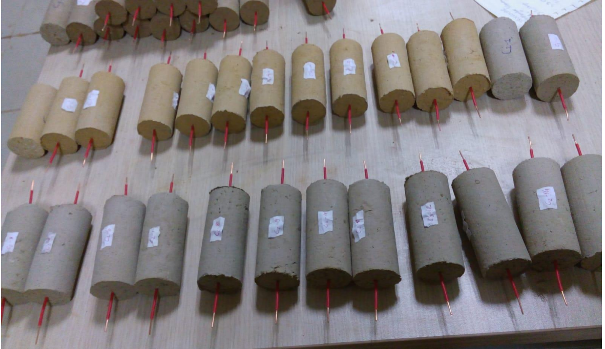
Şekil 2.18. Kalıptan çıkarılmış Canca bölgesi numuneleri
