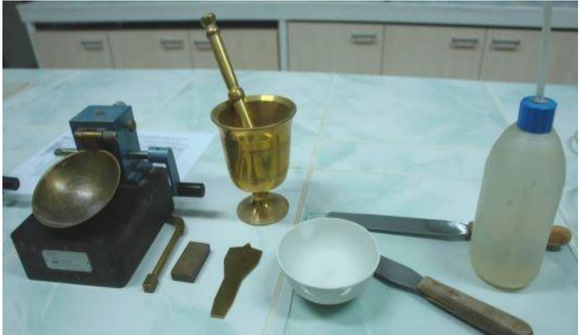
Şekil 2.10. Likit limit deney seti (URL-11).
