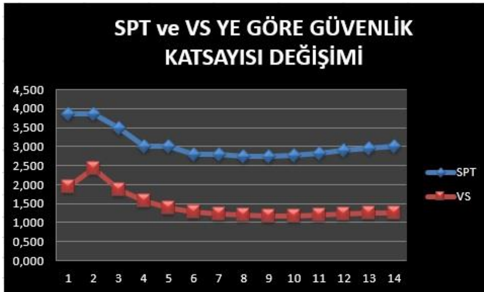
Şekil 5.8. M=7.5 ve a=0.05 g lik ivme için yeraltı suyunun 1 metrede olduğu durum için, SPT ve Kayma Dalga Hızı Vs na göre GK (Güvenlik katsayısının değişimi)
