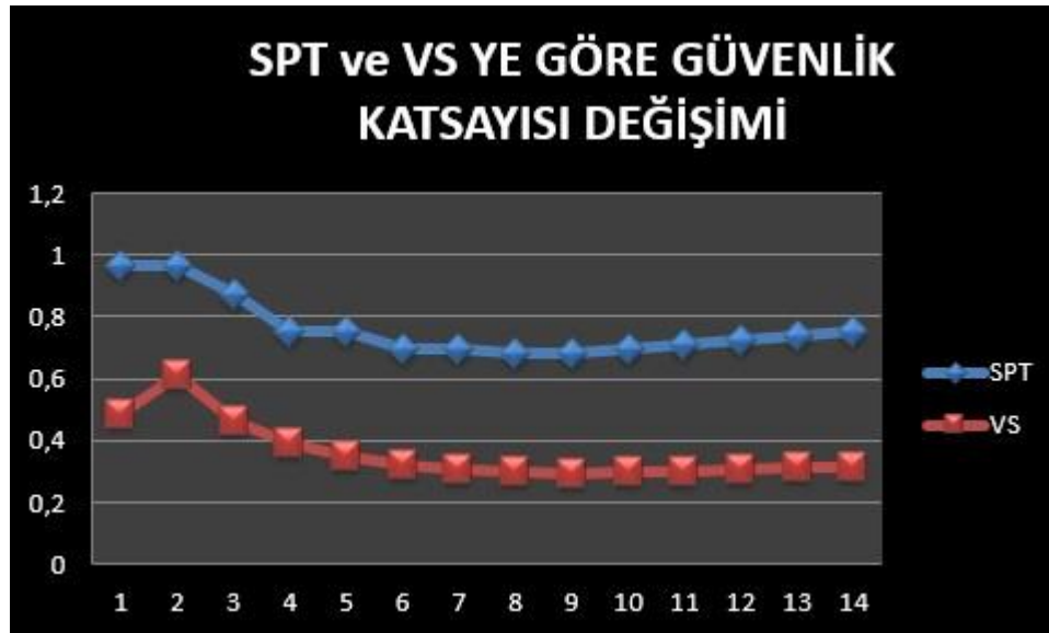
Şekil 5.17. M=7.5 ve a=0.20 g lik ivme için yeraltı suyunun 1 metrede olduğu durum için, SPT ve Kayma Dalga Hızı Vs na göre GK (Güvenlik katsayısının) değişimi
