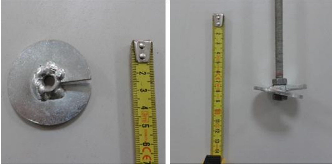
Şekil 2.47. Helisel ankraj (Demir ve Ok 2015)
