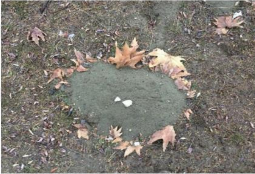
Resim 2. 2. Elâzığ Sivrice’de 24 Ocak 2020’de meydana gelen 6.8 M_w şiddetindeki deprem sonrası gözlemlenen kum kaynamaları görüntüsü (Çetin ve ark., 2020).
