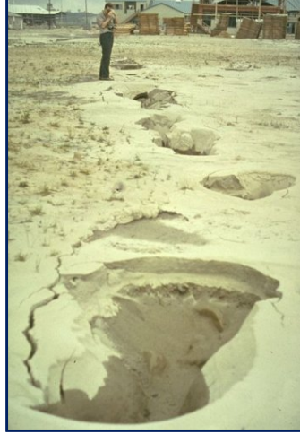
Şekil 3.6. Sıvılaşmaya bağlı kum kaynamalarının etkileri, Niigata, 1964 (Marcuson ve ark.,2007)
