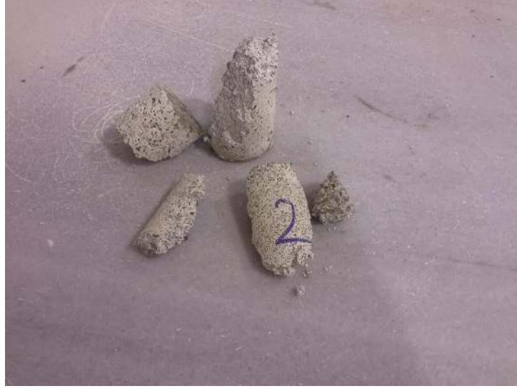
Şekil 4.12. Serbest basınç deneyi ile kırılmış numune
