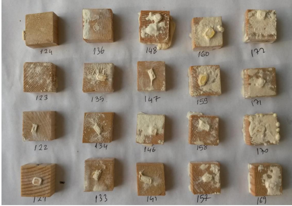
Şekil 3.2. Beyaz çürüklük ( Cv-Coriolus versicolor ) mantarının penetrasyonu-1
