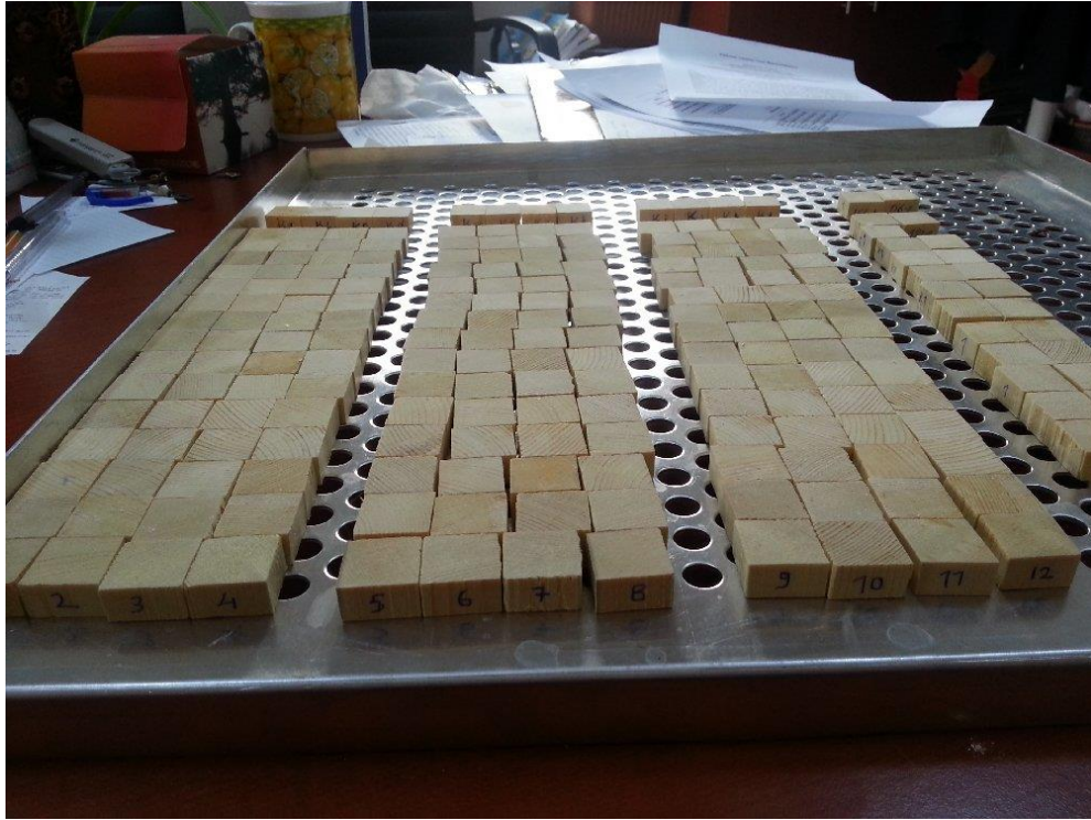
Şekil 2.1. Deney için hazırlanmış sarıçam ve adi dişbudak odun numuneleri
