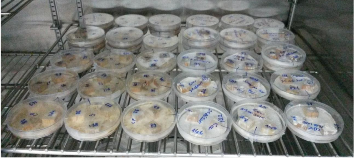
Şekil 2.7. Üç aylık inkubasyon sonunda odun örneklerinde mantar misellerinin gelişimi
