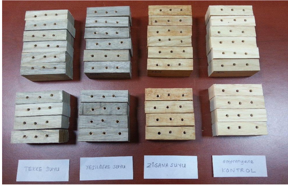
Şekil 3.13. Larva deneyi için hazırlanmış emprenyeli adi dişbudak odun örnekleri
