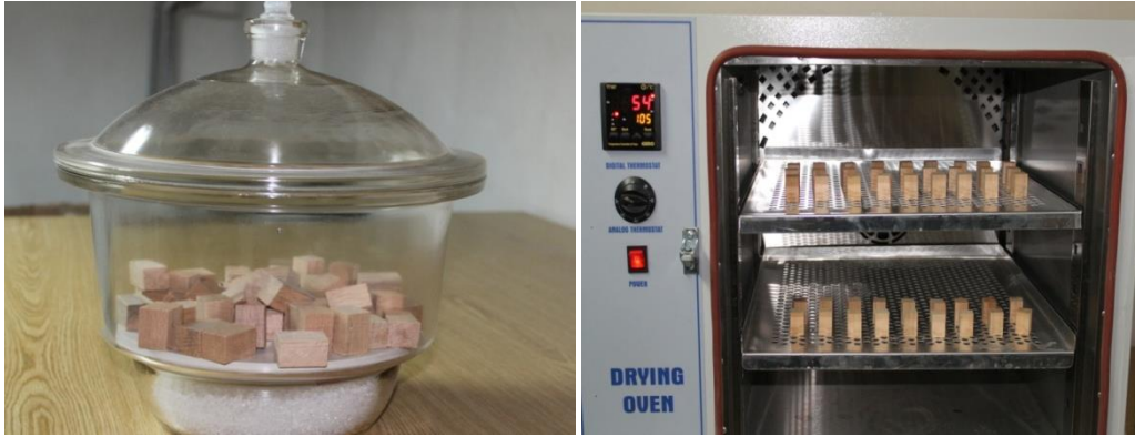
Şekil 2.4. Deney örneklerinin kurutulmasında kullanılan desikatör ve etüv
