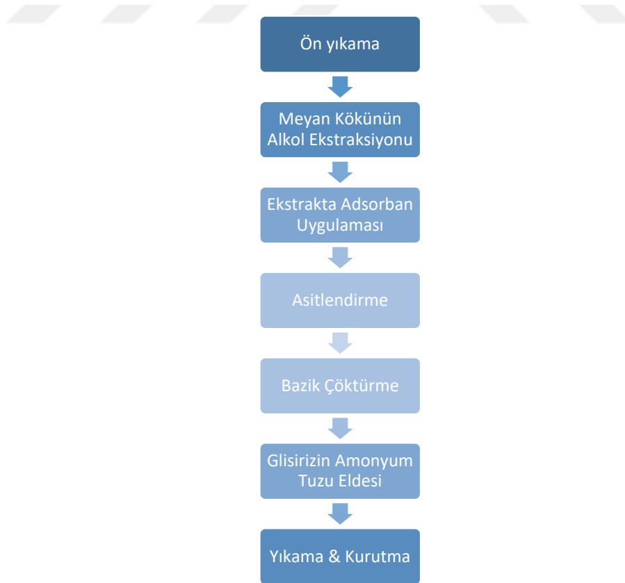
Şekil 2.1. Meyan kökü ekstraksiyonu ve saflaştırma basamakları.
