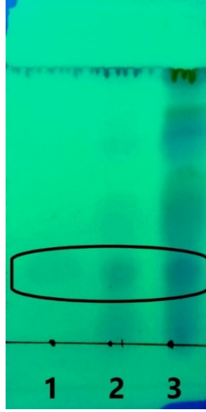
Şekil 3.38. TLC uygulaması sonucu 1) Glisirizin standardı 2) Glisirizin amonyum tuzu 3) Glisirizin etanol ana ekstrakt
