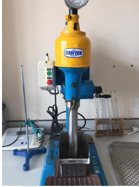
Şekil 3.23. Flotasyon deneylerinde kullanılan Denver flotasyon cihazı
