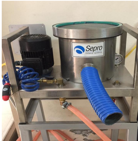
Şekil 3.21. Falcon deneylerinde kullanılan Falcon L40 cihazı
