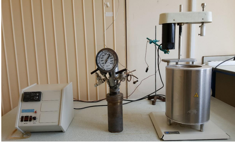
Şekil 3.27. Sıvılaştırma deneylerinde kullanılan kesikli reaktör
