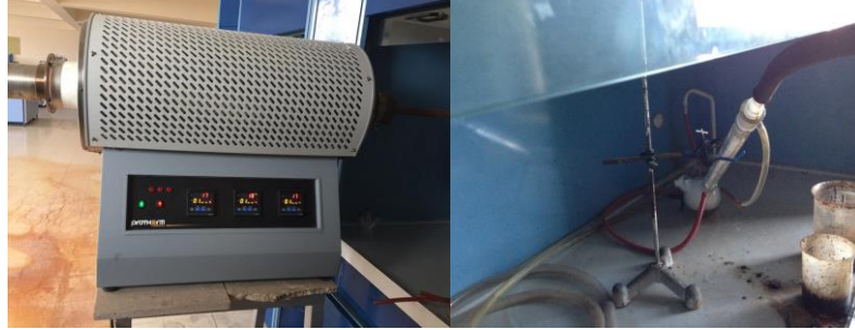
Şekil 3.25. Piroliz deneylerinde kullanılan tüp fırın
