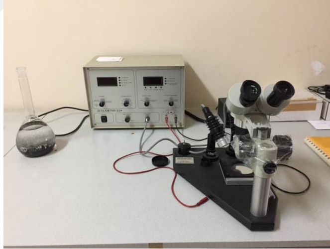
Şekil 3.24. Zeta potansiyel ölçümü için kullanılan zetametre
