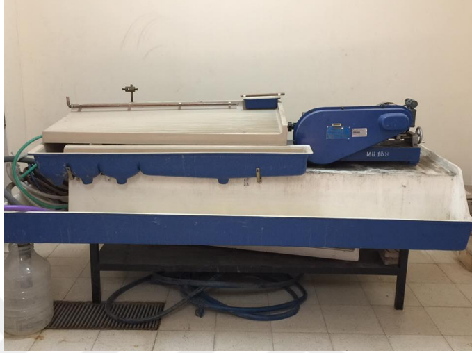
Şekil 3.20. Sallantılı masa deneylerinde kullanılan Wilfley masası
