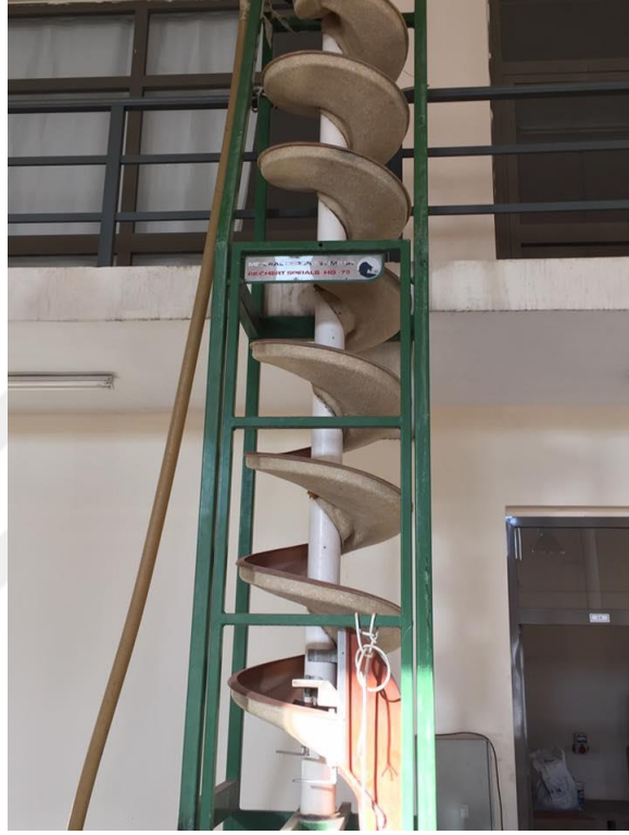
Şekil 3.22. Zenginleştirme deneylerinde kullanılan Reichert spirali
