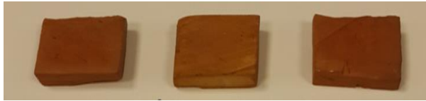
Şekil 3.1. Ham ve Fe +3 yüklemesi yapılmış zeolitler.
