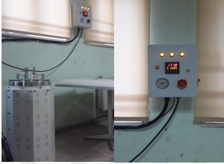
Resim 3.3 Deney örneklerinin otoklav içerisinde kür edilmesi.
