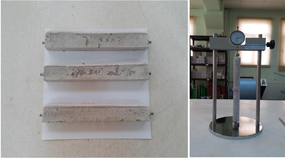
Resim 4.4 Rötre ölçüm çubukları ve komparatör.
