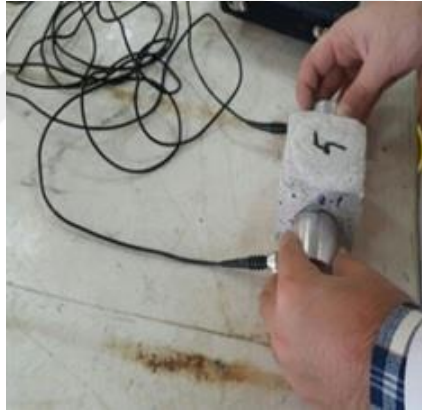
Resim 3.4 Deney örneklerinin ultrases geçiş hızlarının belirlenmesi.
