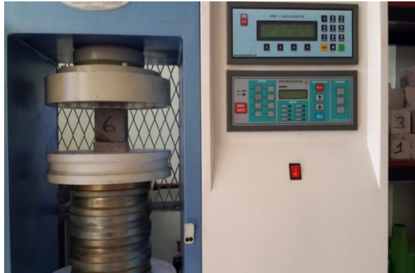
Resim 3.5 Deney örneklerinin basınç dayanımlarının belirlenmesi.
