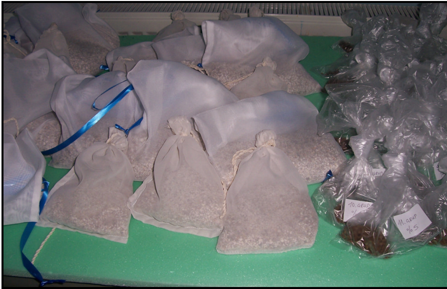
Şekil 4.6. Denemede filtre malzemesi olarak kullanılan tül torbalar içerisindeki zeolit
