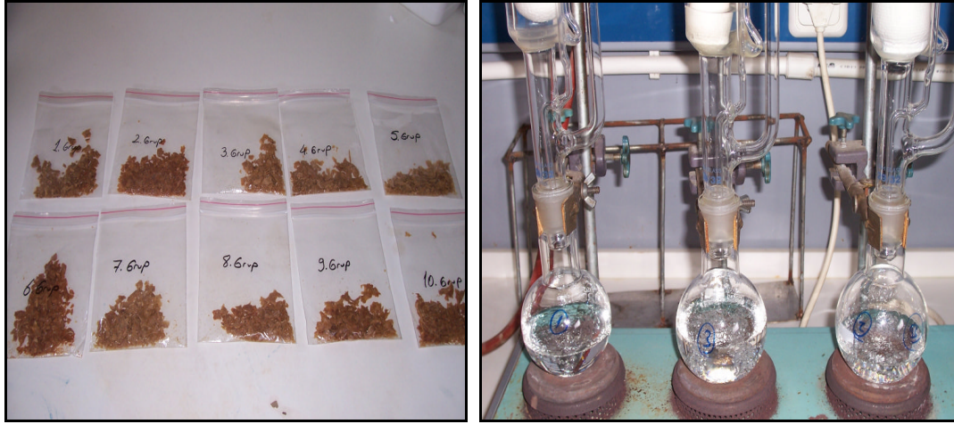
Şekil 5. 8. Balık eti analizinde kullanılan örnekler ve yağ analizi işlemi
