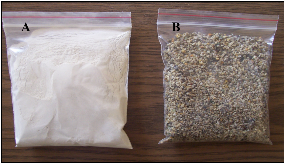
Şekil 4. 4. Yem katkı maddesi olan 100 mikronluk klinoptilolit türü zeolit (A) ve filtre malzemesi olarak kullanılan 1-3 mm'lik klinoptilolit türü zeolit (B)
