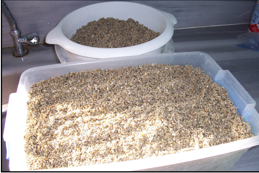
Şekil 4. 5. Denemede filtre malzemesi olarak kullanılan zeolitin yıkama işlemi
