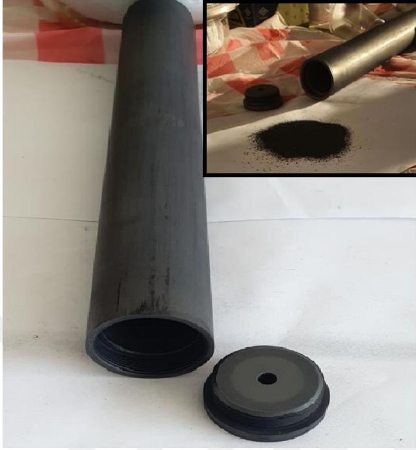
Şekil 5.7. Dinamik sistemde Aktif Karbon üretimi.
