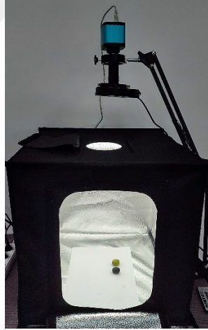
Şekil 2- 2: Zeytin meyvelerinin sınıflandırılması amacıyla kullanılan kapalı görüntüleme kutusu
