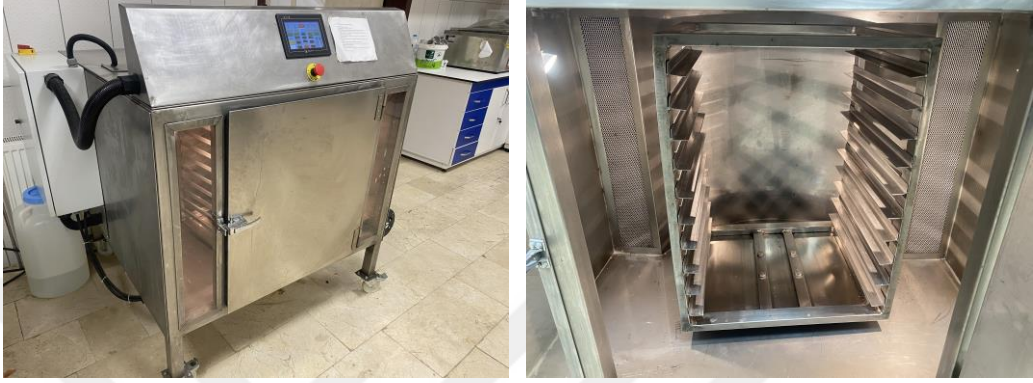
Fotoğraf 3.1. Tepsili kurutma makinesi dış (solda) ve iç (sağda) görünümü.
