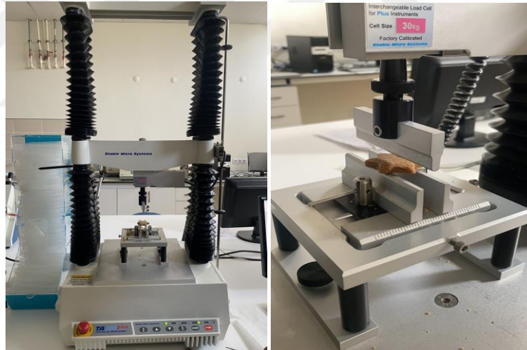
Fotoğraf 3.2. Tekstür analiz cihazı (solda) ve tekstür analizi görseli (sağda).
