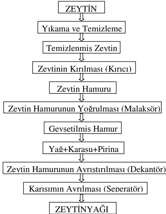
Şekil 1. Zeytinyağı işletmelerindeki işlem adımları ve makina yerleşimi
