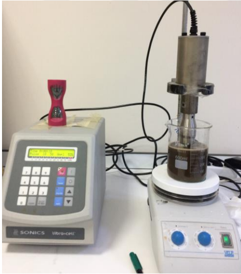
Şekil 3.3. Ultrases destekli fenton bazlı proses deney düzeneğı
