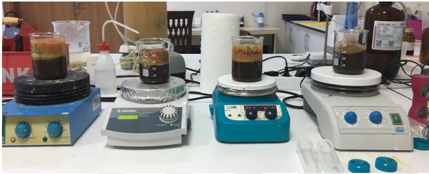
Şekil 3. 1. Fenton bazlı proseslerin deney düzeneği
