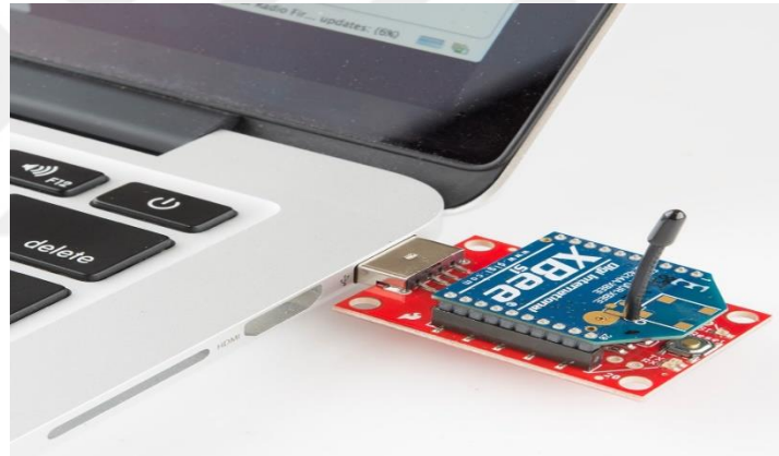
Şekil 4.11 XBee Modülün XBee Explorer ile Bilgisayara Bağlanması
