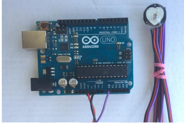
Şekil 4.7 Nabız Sensörü Arduino Bağlantı Diagramı
