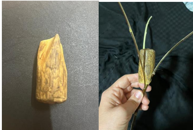
Resim 2.9. Sepet dokumada kullanılan çubuk yarma tahtası ve kullanım şekli (Kösedag, 2024).
