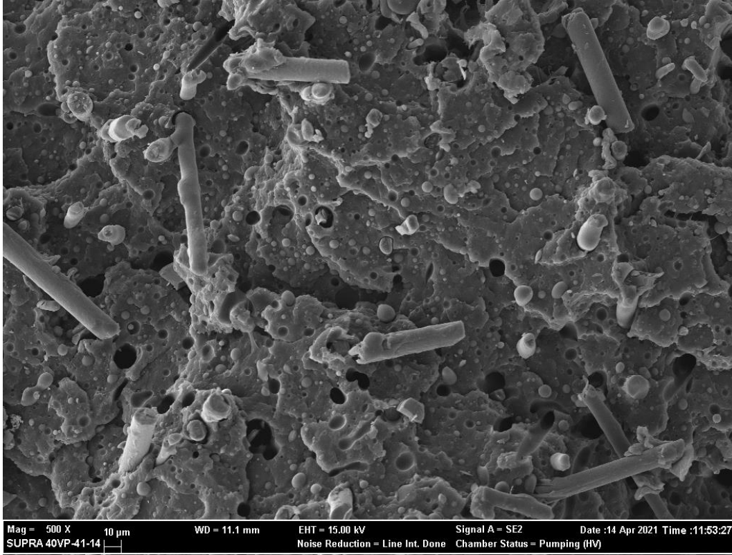
Şekil 4.38. rPET15/GF/CF/T kompozitinin x500 büyütmede kırık yüzey SEM mikrografi
