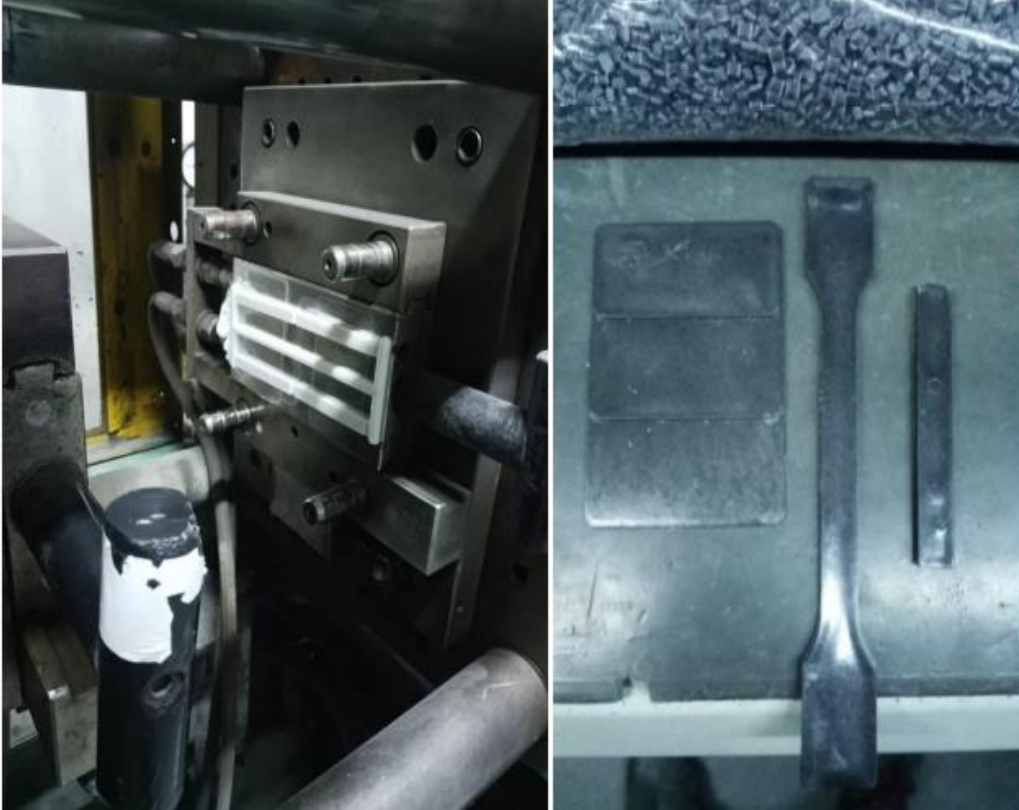
Şekil 3.8. PP/rPET kompozitlerinin enjeksiyon kalıplama prosesi
