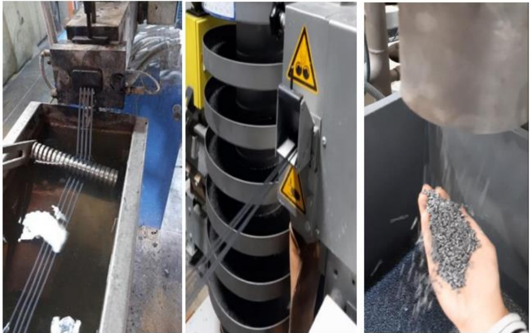
Şekil 3.7. PP/rPET kompozitlerinin ekstrüzyon prosesi
