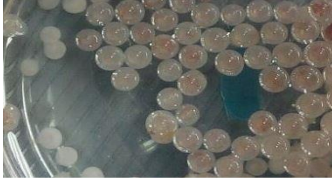
Şekil 8.14. Kitosan-KB-glifosat boncuklarının yaş formundaki görüntüleri
