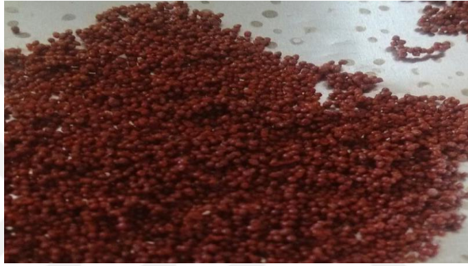
Şekil 8.15. Kitosan-KB-glifosat boncuklarının kuru formdaki görüntüleri
