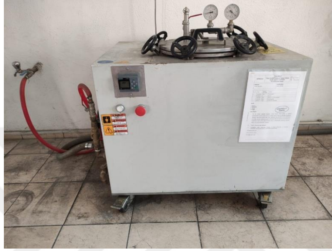
Şekil 5.10. Görünür porozite, yoğunluk ve su emme hesaplamasında kullanılan vakum cihazı
