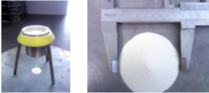
Şekil 4.15 : Hall hunisi ile akış testi düzeneği.
