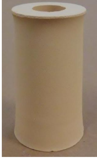
Şekil 5.35 : Endüstriyel olarak üretilen ilk zirkonya esaslı refrakter nozul.
