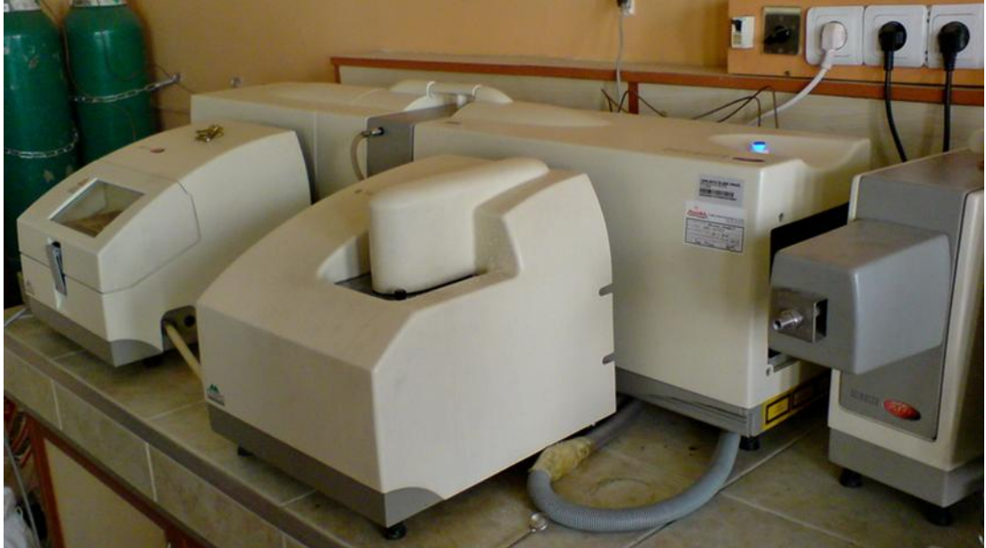
Şekil 4.13 : Malvern lazerli tane boyut ölçüm cihazı.
