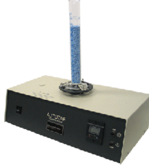
Şekil 4.14 : Quanthachrome Auto tap cihazı.
