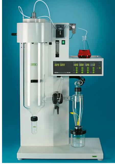
Şekil 4.9 : Buchi model laboratuvar tipi püskürtmeli kurutucu (spray dryer).
