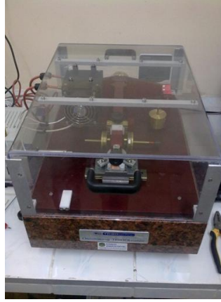
Şekil 4.18 : Tribotech model aşınma test cihazı.
