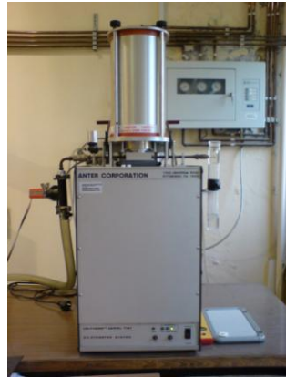
Şekil 4.17 : Anter dikey tip dilatometre.
