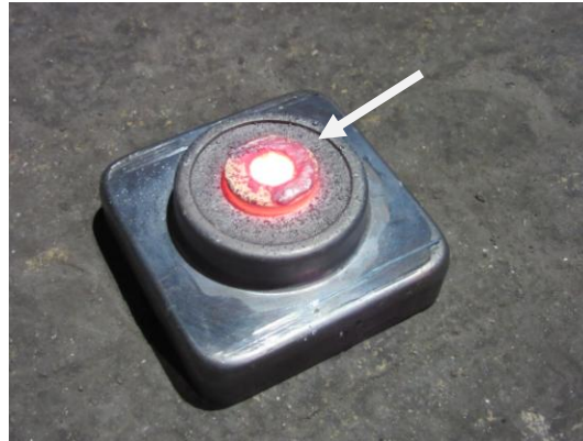
Şekil 5.36 : 2.5 saat servis sonrası devre dışı kalan refrakter nozul görüntüsü.
