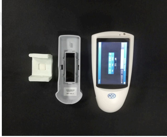
Şekil 3.14. Soldan sağa, parlaklık ölçümü için hazırlanan silikon kalıp, kalibrasyon plakası ve parlaklık ölçer
