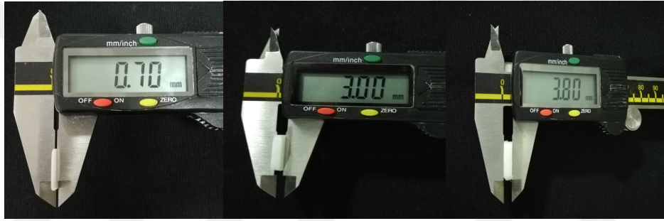
Şekil 3.10. Sırasıyla soldan sağa CAD-CAM bloktan elde edilen kesit, Delrin ve simante edilmiş numunenin final kalınlığı
