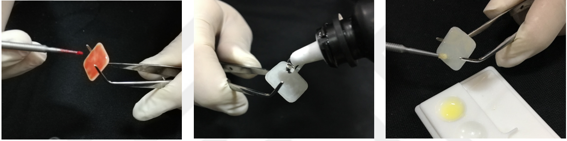
Şekil 3.8. CAD-CAM bloklardan elde edilen numunelerin yüzeyinin simantasyona hazırlanması
