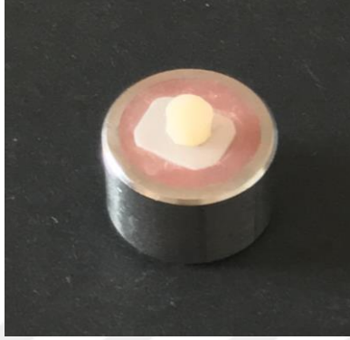
Şekil 3-14: Kompozit disk yapıştırılan örnek
