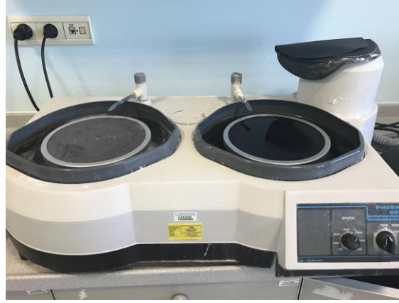
Şekil 3-6: Örneklerin yüzeylerinin düzeltilmesi
