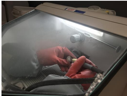
Şekil 3-8: Örnek yüzeyine kumlama işleminin uygulanması
