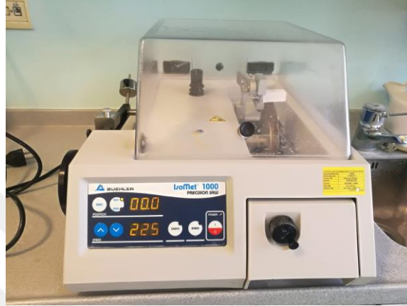
Şekil 3-2: Isomet 1000 (Buehler) hassas kesme cihazı
