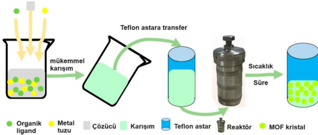
Şekil 6.5. Hidrotermal/solvotermal metotla MOF sentezinin şematik diyagramı [189].
