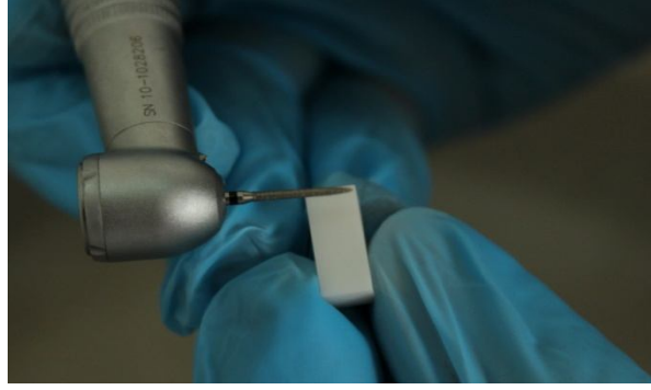
Resim 14: Zirkonya yüzeyinin frezle aşındırılması
