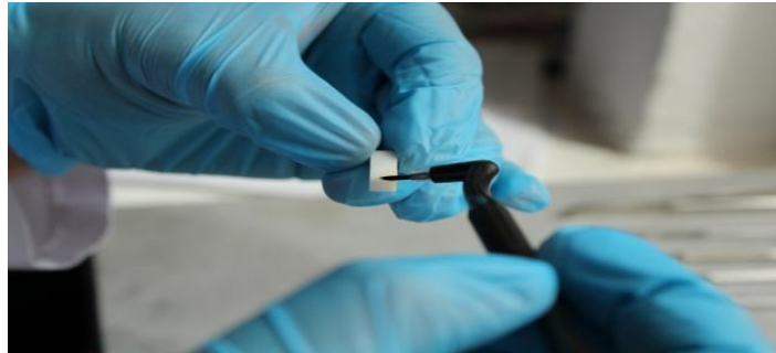
Resim 26: Aşındırılmış zirkonya yüzeyinin fırçayla temizlenmesi
