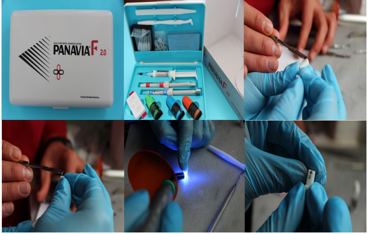
Resim 12: Zirkonya örneğin yüzeyine tam seramik örneğin simantasyonu
