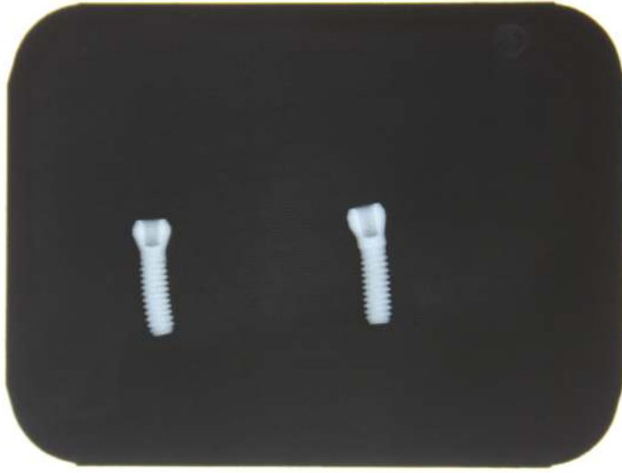
Şekil 4.16: Eğilen vidaların radyografı
