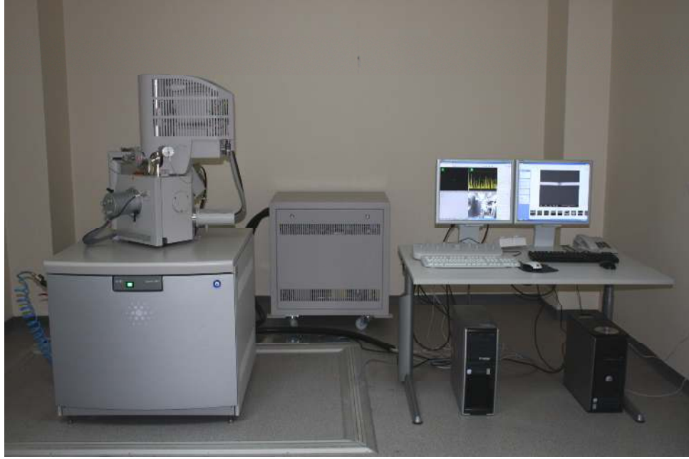
Şekil 3.12: Scanning Electron Mikroskobu, dijital görüntü işlemcisi ve güç devresi
