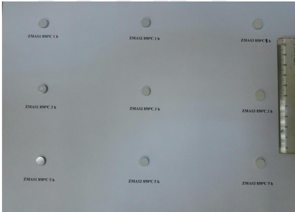
Şekil 4.8. 850°C sıcaklıkta 1, 3 ve 5 saat sürelerde sinterlenen ZMAS-1 ZMAS-2 ve ZMAS-3 cam-seramiklere ait makro görüntüler
