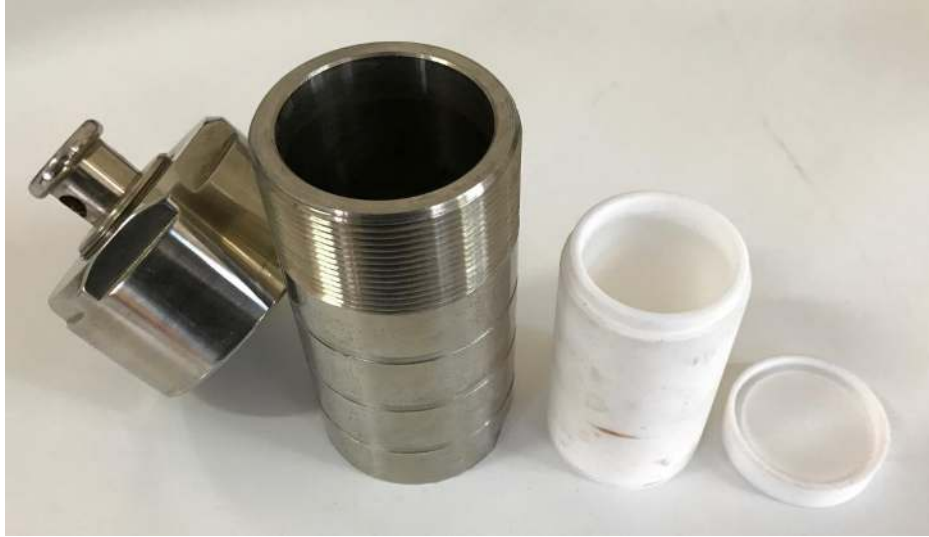
Görsel 3.1. Kristal büyütülmesi için kullanılan çelik dış kap ve teflon iç kaptan oluşan otoklav cihazı
