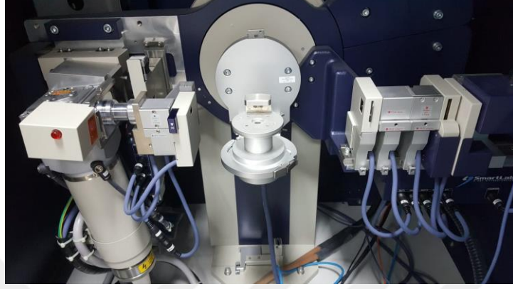
Görsel 2.1. Rigaku SmartLab XRD cihazının gonyometresi
