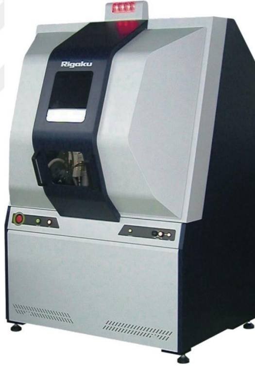
Görsel 2.1. Rigaku SmartLab XRD cihazının gonyometresi
