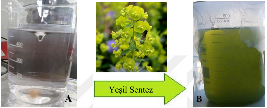
řekil 4.1. ZnO nanopartiklnn yeřil sentezinin řematik gsterimi A: ZnCl 2 zltisi, B: ZnO nanopartikl
