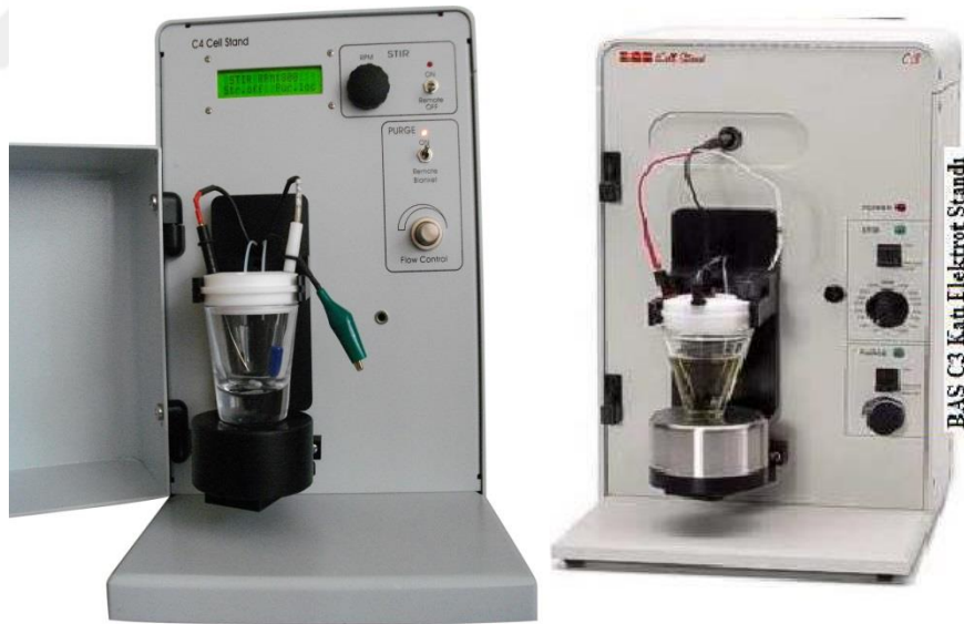
Şekil 3.1. Elektrokimyasal çalışmalarda kullanılan hücre standları
