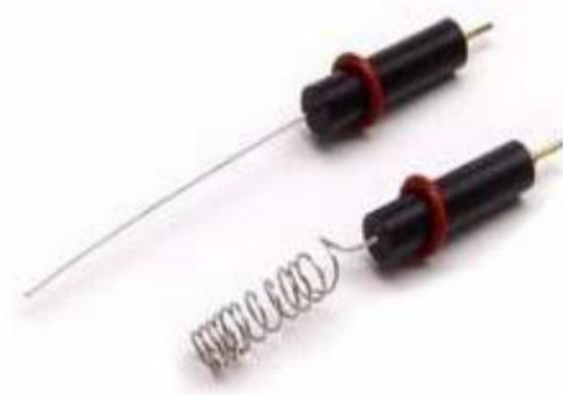
Şekil 3.5. Platin tel karşıt elektrotlar
