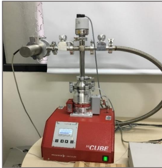
Şekil 32. Vakum atmosferinde ısıtım sistemi
