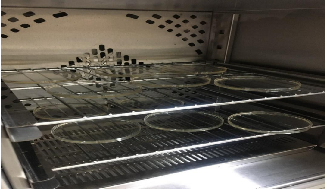
Şekil 2.3. Kitosan film (Kontrol grubu, K), Kitosan/%1 ZnO-NP film (K+Ç), Kitosan/AÇM film (K+A), Kitosan/Ayva çekirdeği müsilajı/ZnO-NP biyonanokompozit (K+A+Ç) filmlerin petrilere dökülmesi (a) ve etüvde kurutulması işlemi (b) (Orijinal resim)
