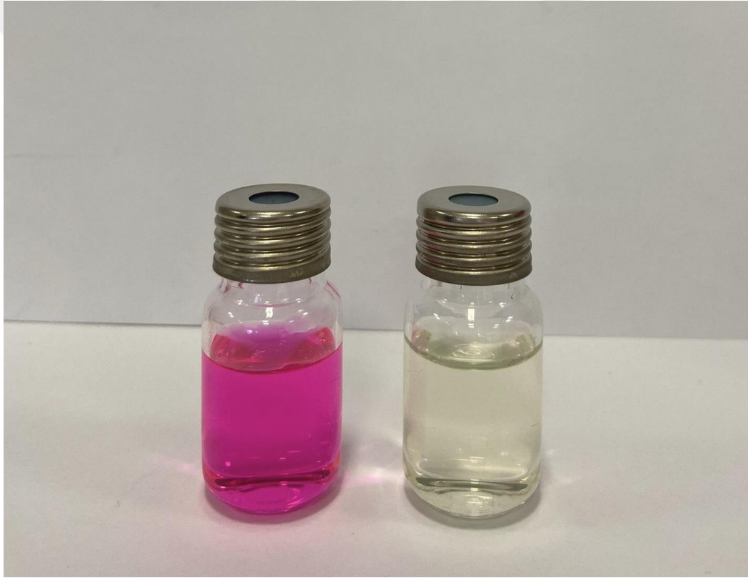
Şekil 4.43. 5 mgL -1 konsantrasyonuna sahip Rodamin B'nin fotobozunma öncesi ve sonrası
