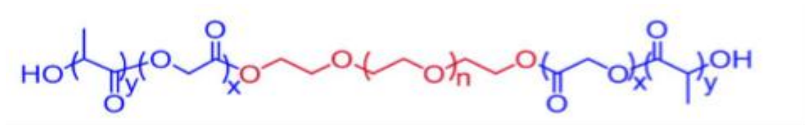
Şekil 2-5: PLGA-PEG-PLGA kimyasal yapısı – Yang ve ark. (2018)’ dan
