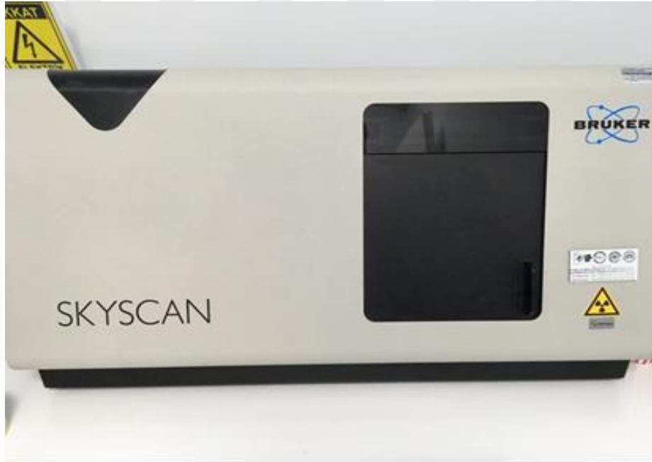
Şekil 3-7: SkyScan 1174v2 (Kontich- Belgium) bilgisayarlı tomografi cihazı
