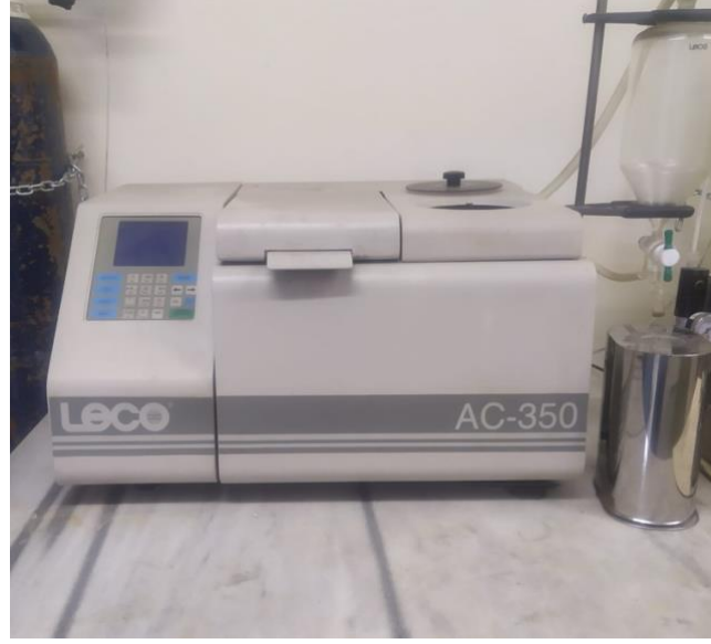
Şekil 3.2. Kalori ölçümü için kullanılan Leco marka kalorimetre
