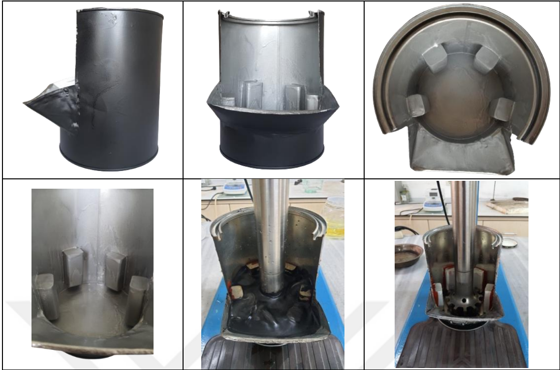
Şekil 3.3. Deneysel olarak tasarlanan agloflotasyon hücresi
