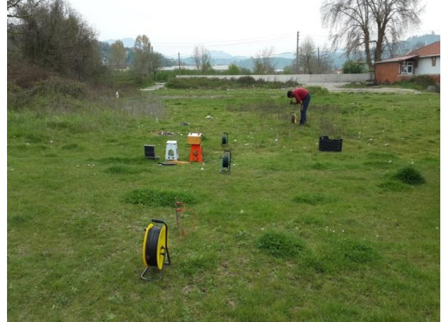
Şekil 5.2 Gerçekleştirilen jeofizik sismik ölçüm çalışmalarından görüntüler.
