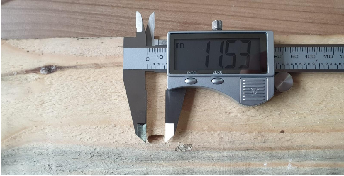
Şekil 4.3: Dijital Kumpas Yardımıyla Böcek Deliğinin Ölçülmesi (Fotoğraf: Ertan ALBAS)
