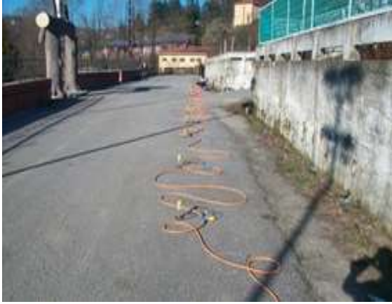
Şekil 5.9 Sismik kırılma, sismik yansıma ve yüzey dalgası analizi dalgalarının arazide elde edilmesi
