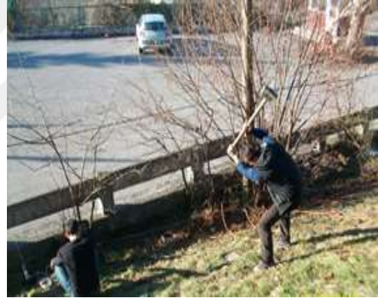
Şekil 5.9 Sismik kırılma, sismik yansıma ve yüzey dalgası analizi dalgalarının arazide elde edilmesi
