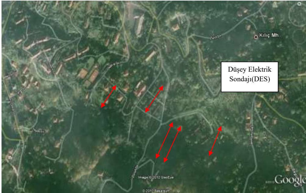
Şekil 5.13 İnceleme alanındaki düşey elektrik sondajların konumları
