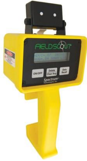
Şekil 3.5. Araştırma kapsamında kullanılan klorofil metre (FIELDSCOUT CM 1000)
