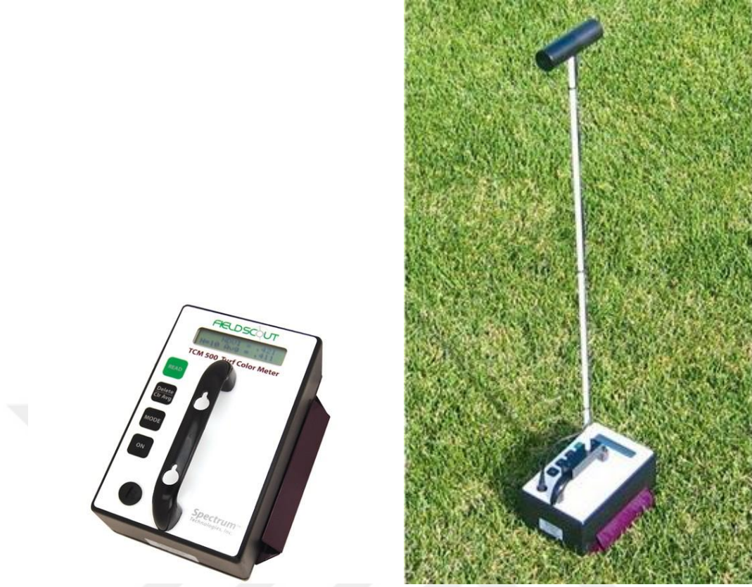
Şekil 3.4. NDVI verilerini almak üzere kullanılan ekipman ‘TCM 500 “NDVI” meter görüntüsü
