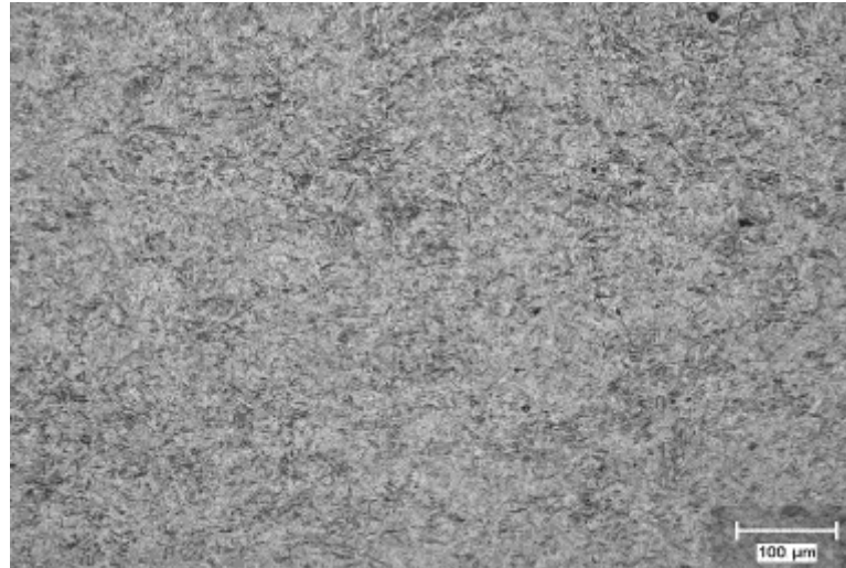
Şekil 3.3. Su verme sonrası 350°C'de iki saat süreyle menevişlenmiş AISI 4140 çeliğine ait mikroyapı [26].
