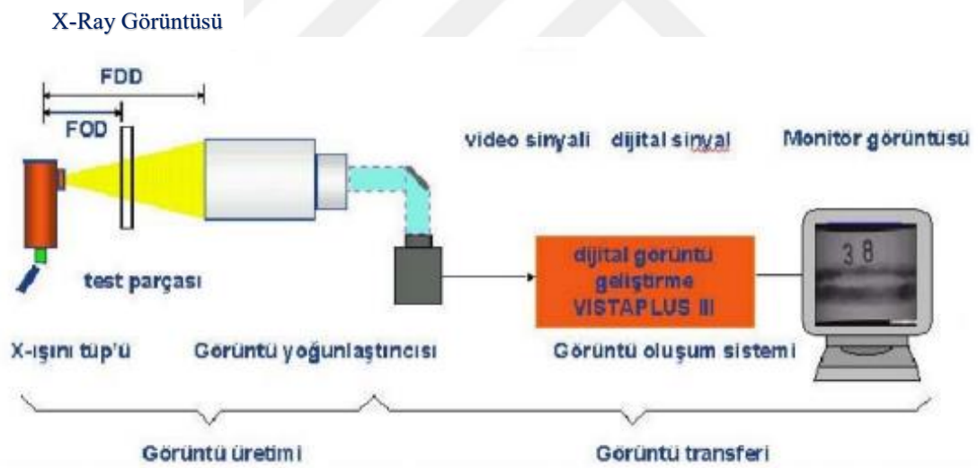
Şekil 6.9. Radyoskopi yönteminin şematik görünümü [51].
