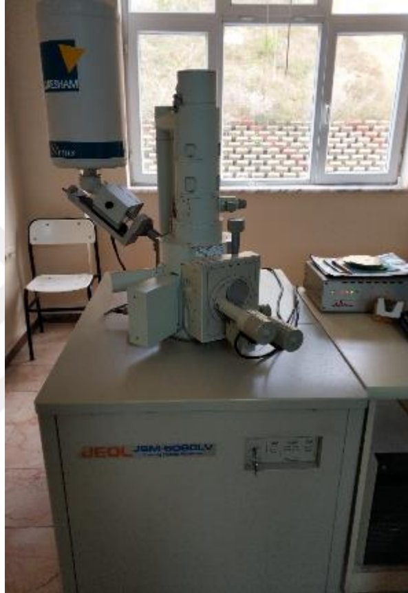
Şekil 7.25. Jeol JSM- 6060LV Model SEM cihazı (Taramalı elektron mikroskobu).
