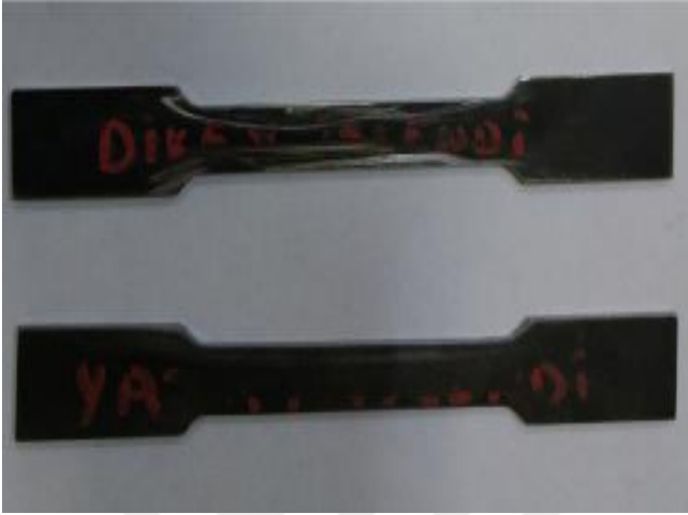
Şekil 4.4. Ck 75 sacdan hazırlanan çekme numuneleri.
