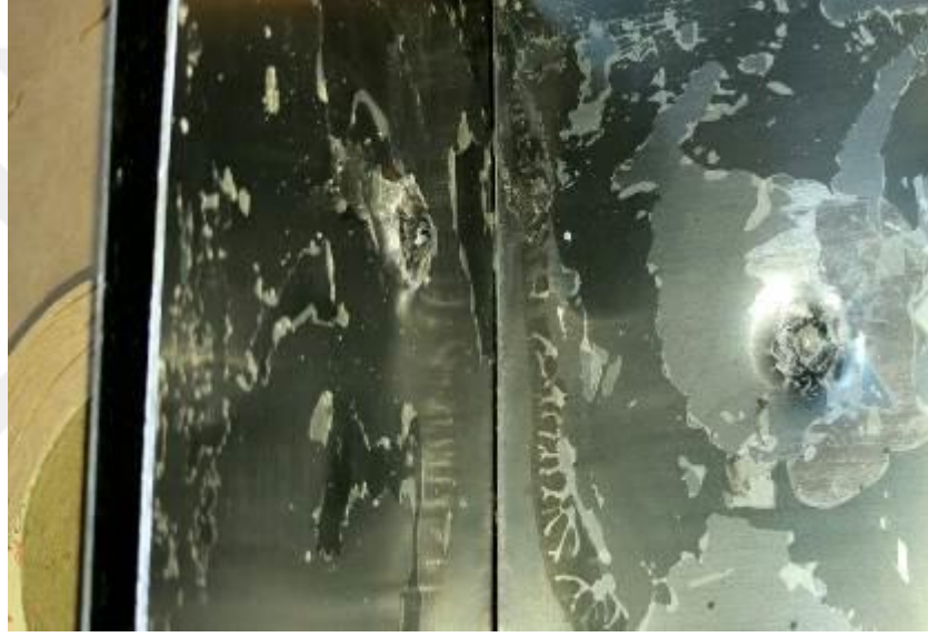
Şekil 4.9. 13 mm numune ön yüz ve delinmiş 2mm sac
