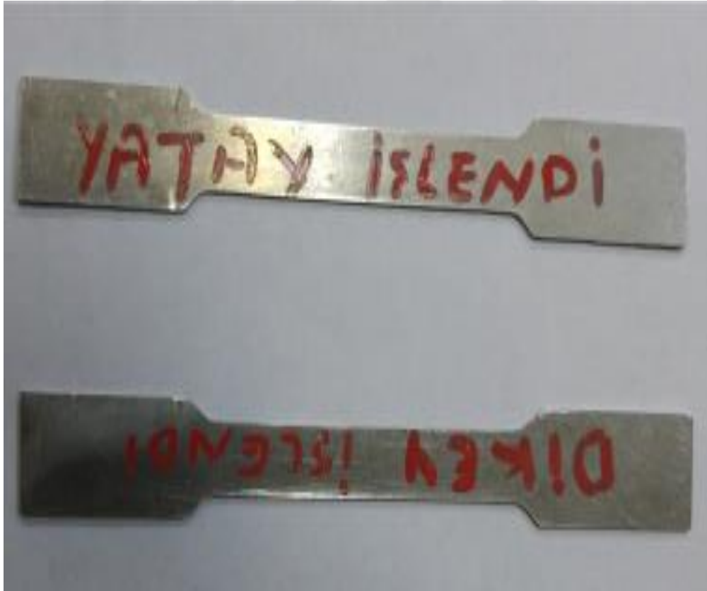
Şekil 4.5. Al 7075 T6 sacdan hazırlanan çekme numuneleri.
