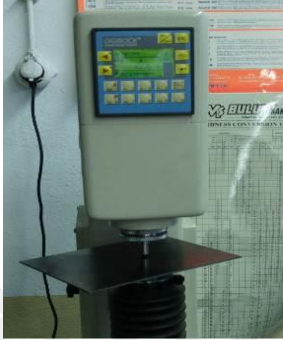
Şekil 4.2. Sac malzemenin sertlik ölçümü.
