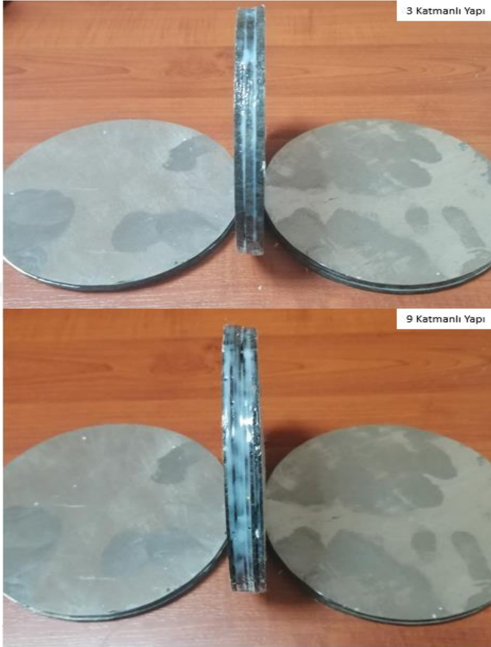
Şekil 3.6. Epoksi yapıştırıcı ile birleştirilmiş 3 ve 9 katmanlı yapılar
