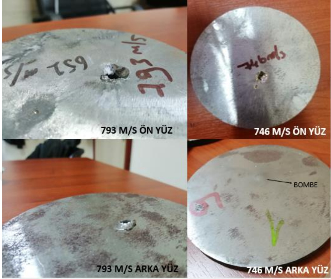
Şekil 4.1. Yekpare 4340 yapıların atış sonrası deformasyonları
