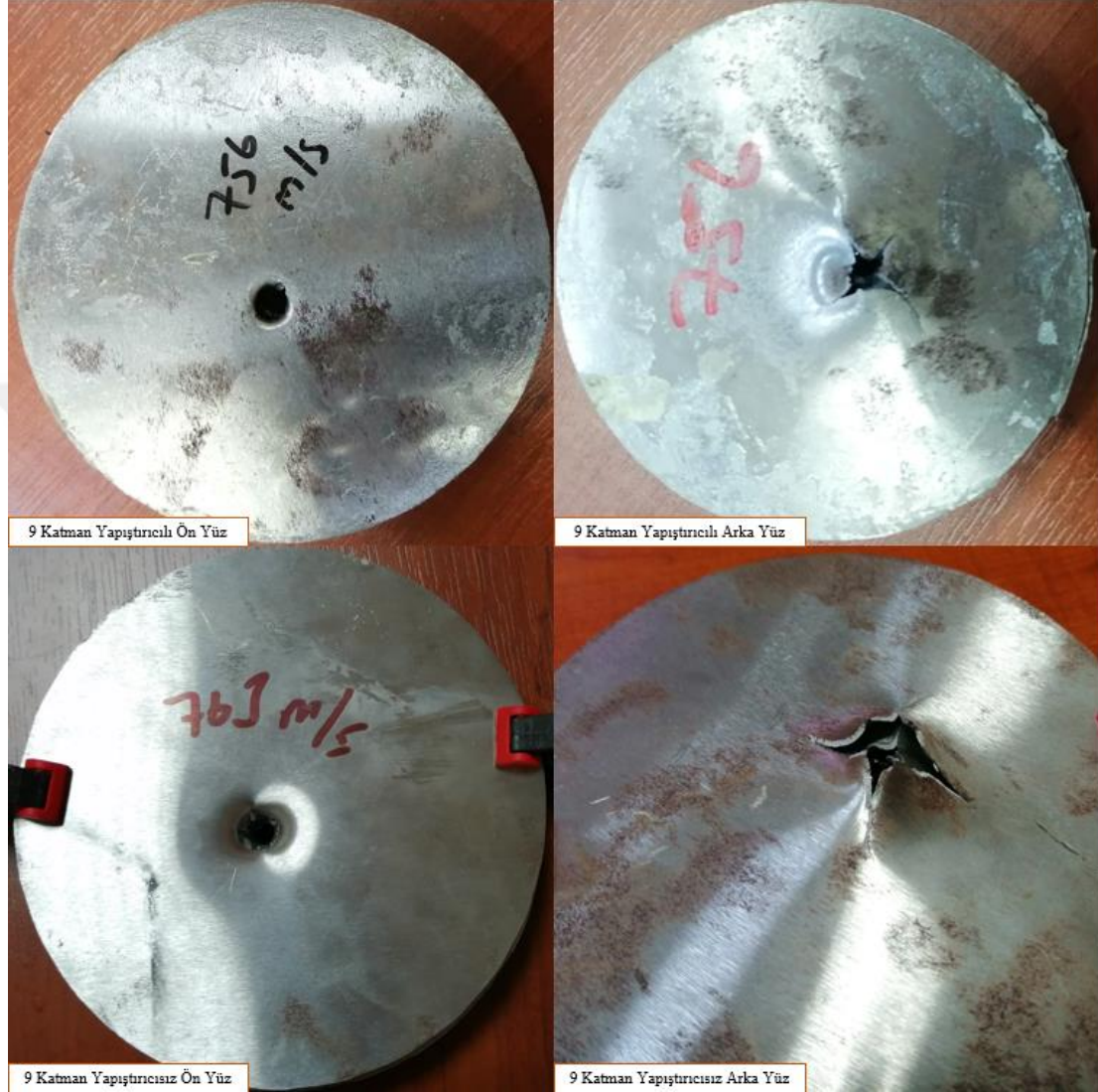
Şekil 4.3. 9 katmanlı 4340 yapıların atış sonrası deformasyonları
