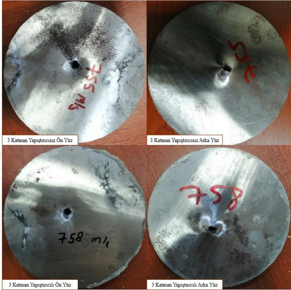
Şekil 4.2. 3 katmanlı 4340 yapıların atış sonrası deformasyonları
