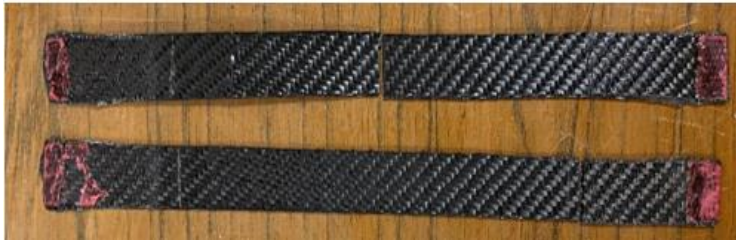
Resim 6.36. Karbon fiber çekme numuneleri.
