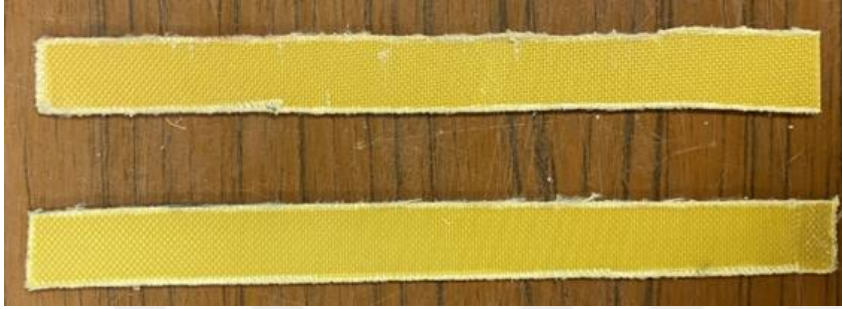
Resim 6.37. Aramid (Kevlar) çekme numuneleri.
