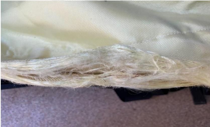
Resim 6.1. EOD 9 Model Bomba Uzmanı Elbisesinin Ceket İç Yapısı.
