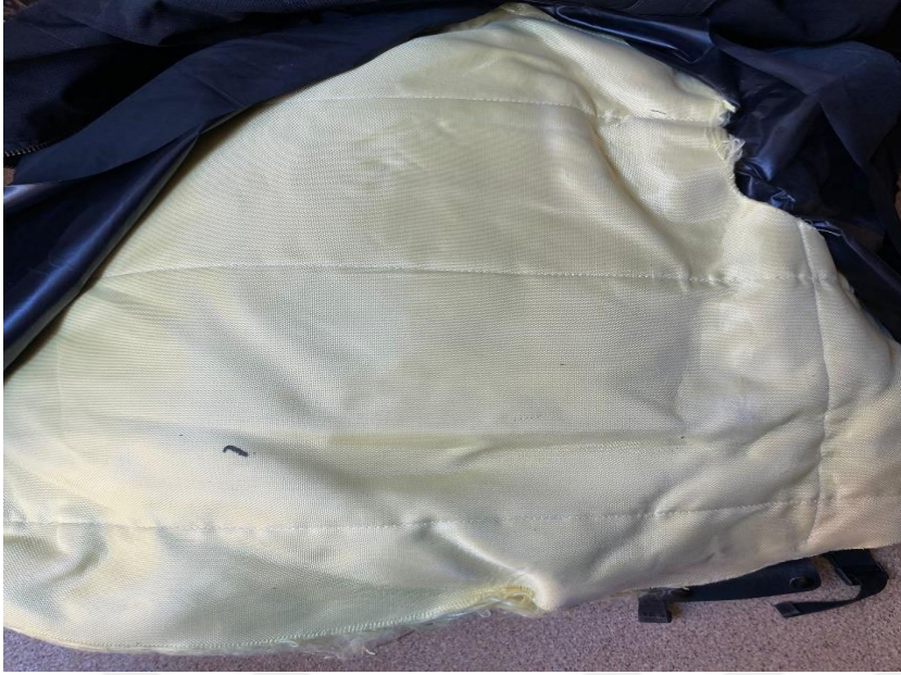
Resim 6.2. EOD 9 Model Bomba Uzmanının Ceket Kumaş Yapısı.
