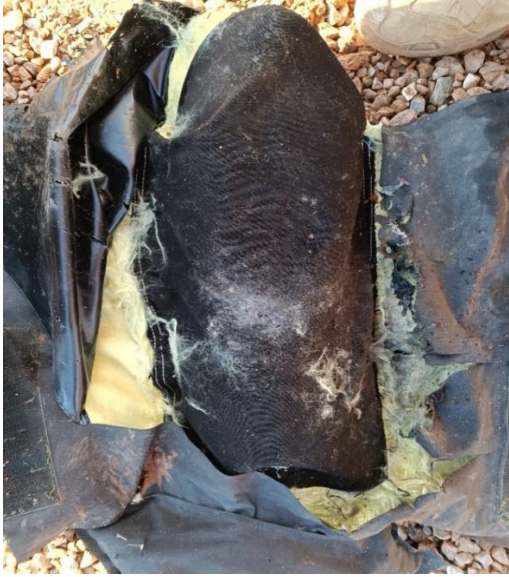
Resim 6.32. Karbon fiber ve aramid katmanlı diz altı ön kısmında oluşan parça etkisi
