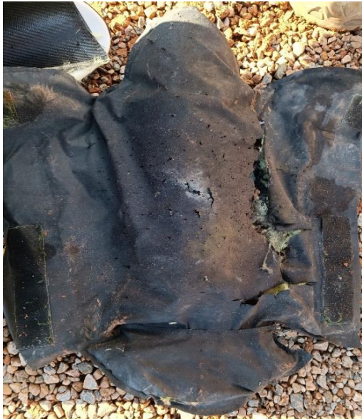
Resim 6.30. Orijinal diz altı ön kısmında oluşan parça etkisi
