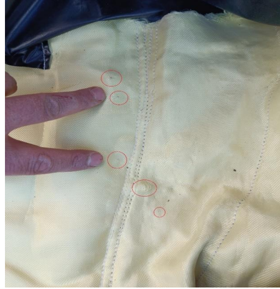
Resim 6.33. Karbon fiber ve aramid katmanlı diz altı arka kısmında oluşan parça etkisi
