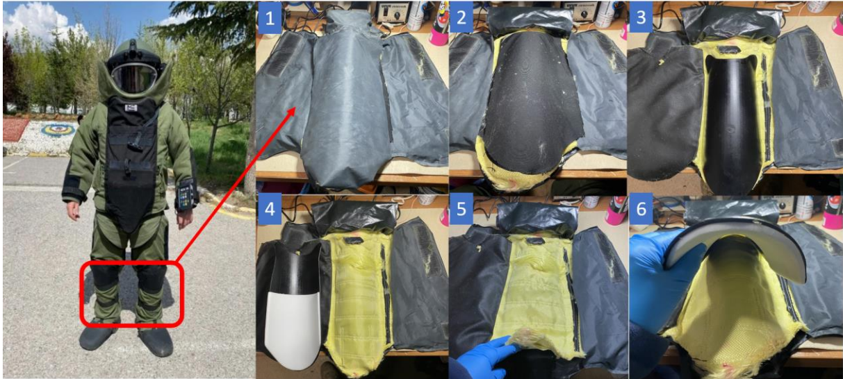
Resim 6.26. EOD 9 Model Bomba Uzmanı Elbisesi pantolon diz altı kısmı orijinal iç yapısı.
