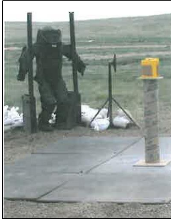
Resim 5.16. 10 kg C4, 3.0 m uzaklık ve 1 m yükseklikte.
