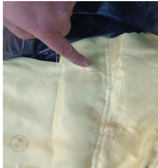
Resim 6.31. Orijinal diz altı arka kısmında oluşan parça etkisi
