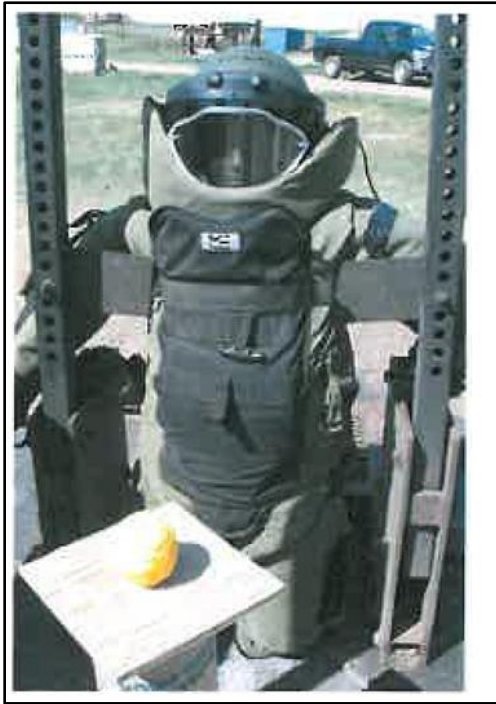
Resim 5.15. 0,567 kg C4, 70 cm Yükseklikte 60 cm uzaklık mesafesi.
