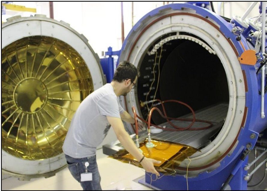
Resim 3.5. Otoklav kazanı ve kompozit üretimi.
