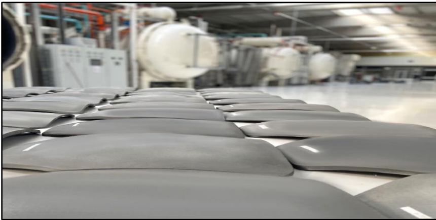
Resim 1.7. Kayseri KİM Teknoloji fabrikasında üretilen bor karbür, Silisyum karbür seramik zırhlar.
