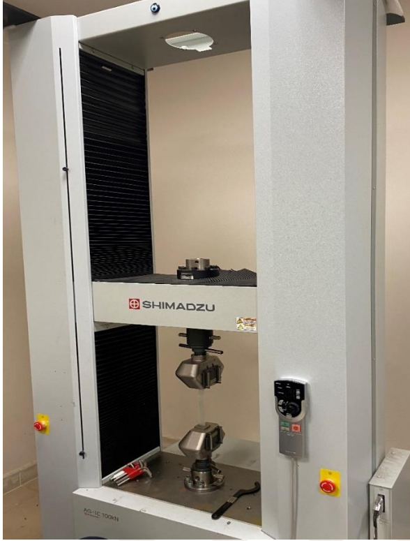
Resim 6.34. SHIMADZU marka AG-IC 100kN model çekme test cihazı.
