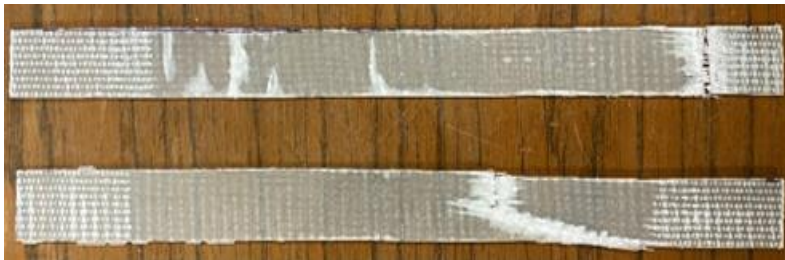
Resim 6.35. Cam fiber çekme numuneleri.
