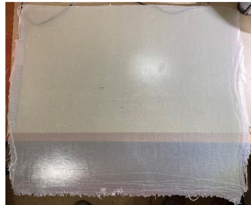
Resim 6.9. Vakum infüzyon ile üretilen cam fiber kompozit.
